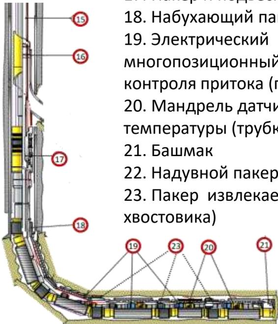
**Забойные станции** включают в свой состав трубку Вентури, датчик электрической емкости, датчики давления и температуры, а также бесступенчатый клапан-регулятор потока.
