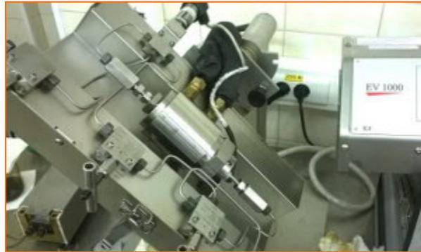
Электромагнитный вискозиметр EV 1000 (SPSI 440) (на фото термостат снят)  $\mu=0,02-10000$  сПз ( $\Delta \pm 1\%$ ); до  $+190^\circ\text{C}$ , 100МПа
