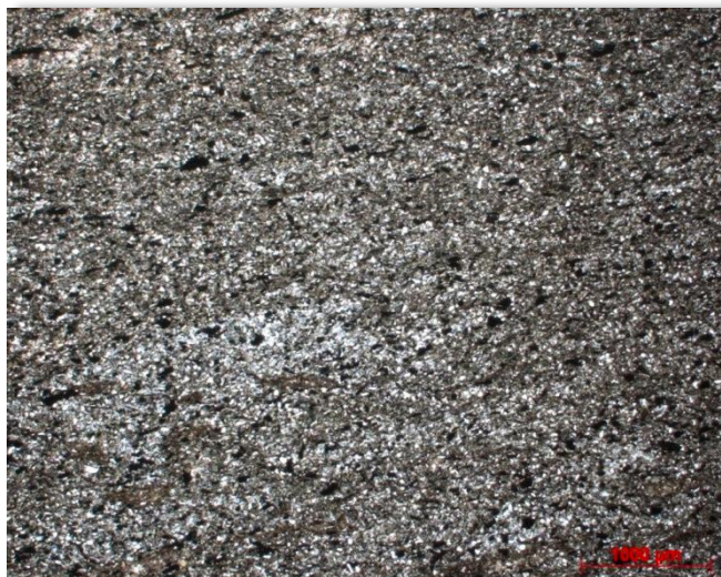
Алевролит мелкозернистый неравномерно глинистый, слабо сидеритизированный Проксимальная часть дальней зоны подводного берегового склона. Кпр ~1мД скв.3, глуб. 780,12м, х25, николи II
