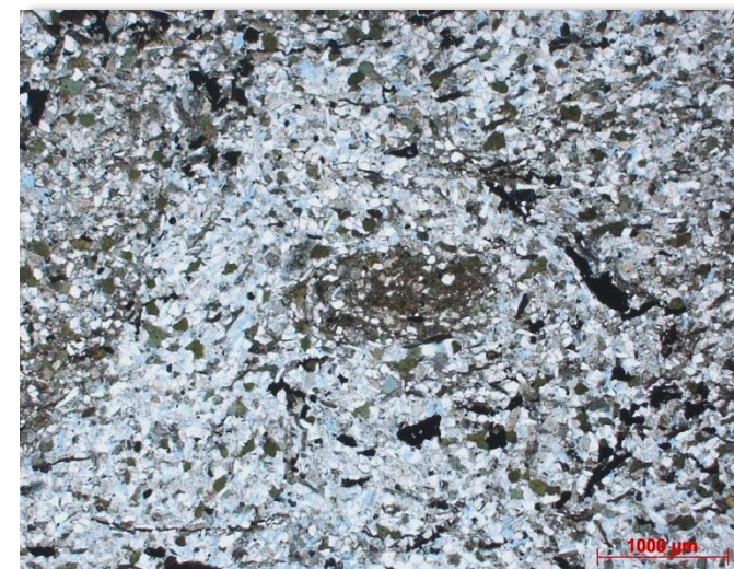
Песчаник тонкозернистый алевроитовый, неравномерно глинистый, биотурбированный Дистальная часть предфронтальной зоны пляжа. Кпр ~33мД скв. 3, глуб. 776,5м, х25, николи II
