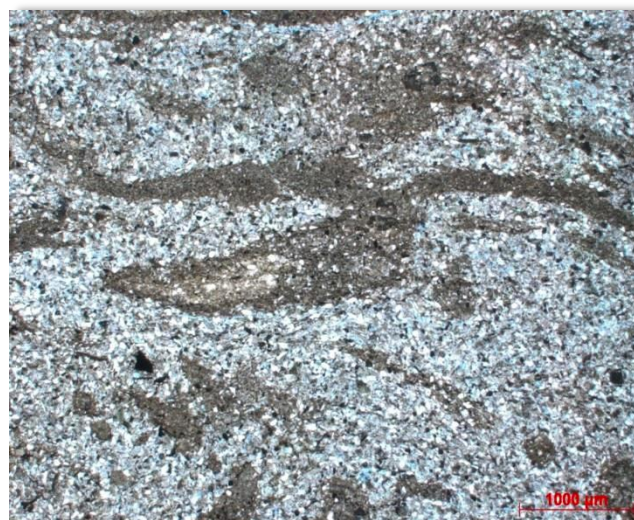
Алевролит мелкозернистый неравномерно глинистый, биотурбированный Переходная зона Кпр ~9мД скв. 3, глуб. 762,3м, х25, николи II
