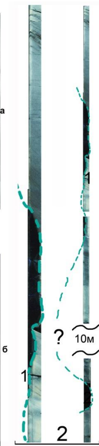
Рис.11. Фотоизображения (1) керна, в ДО (а) и УФО (б). Фрагмент керна (2) в зоне локальной кальцитизации. КERN 15_1_249, глубина 2390-2411м
