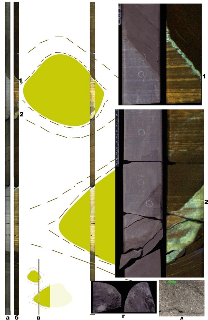
Рис.19. Будиноиды. Фото-, скано- и микроизображения правильных спилов ядра. Реконструкция крупных будиноидов (в). Контакты с зеркалами скользя (г), «выпоты» нефти (д) в зоне деструкции
