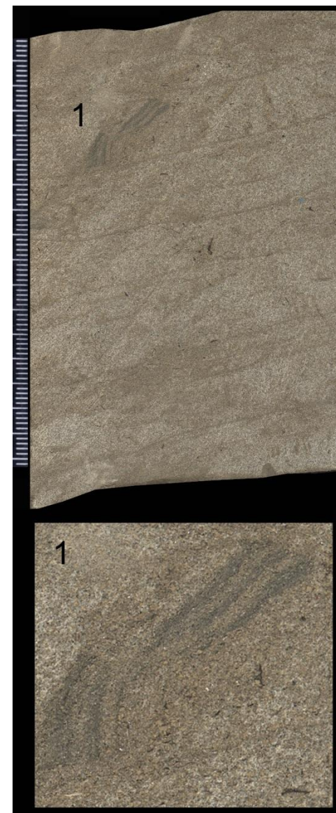
Рис. 22. Пример тектонического «стирания» первичной текстуры. Песчаник нефтенасыщенный с тонкой субпараллельно-линейной текстурностью, с реликтами первичного текстурного рисунка между кливажными линиями
