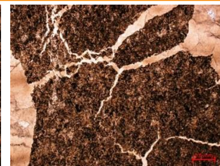
Известняк спикуловый тонкозернистый, с глинистым веществом и сидеритом в межкристаллическом пространстве, с редкими включениями пирита, первично трещиноватый, со вторичной блоковой кальцитовой и доломитовой цементацией по трещинам, а так же слабой терригенной примесью по ним же, плотный. Фото шлифа, николи II.
