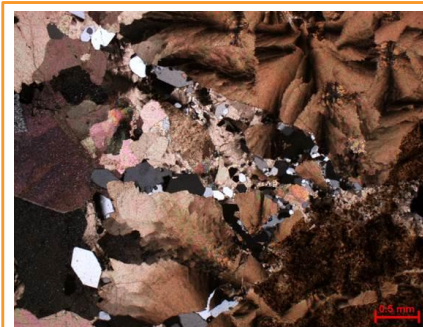
Известняк спикуловый тонкозернистый, с глинистым веществом и сидеритом в межкристаллическом пространстве, с редкими включениями пирита, первично трещиноватый, со вторичной блоковой кальцитовой и доломитовой цементацией по трещинам, а так же слабой терригенной примесью по ним же, плотный. Фото шлифа, николи II.
