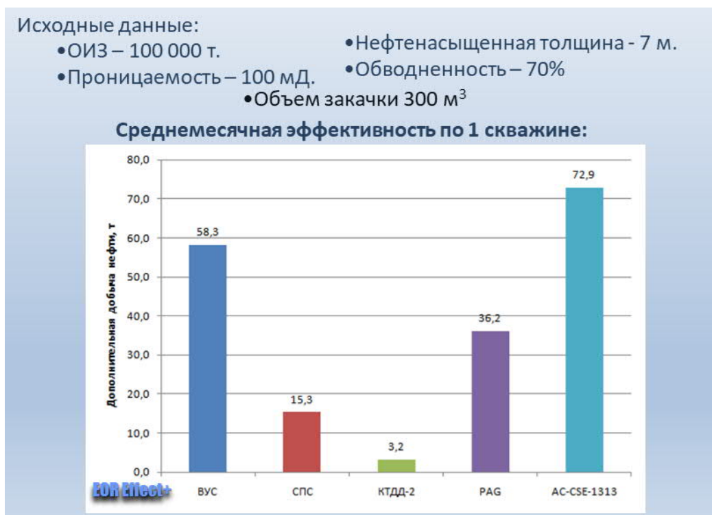
Рис. 5. Рейтинг эффективности технологий для рассматриваемой скважины-кандидата на проведение геолого-технических мероприятий выравнивания профиля приемистости полученный в результате моделирования на основе обучения нейронных сетей.
