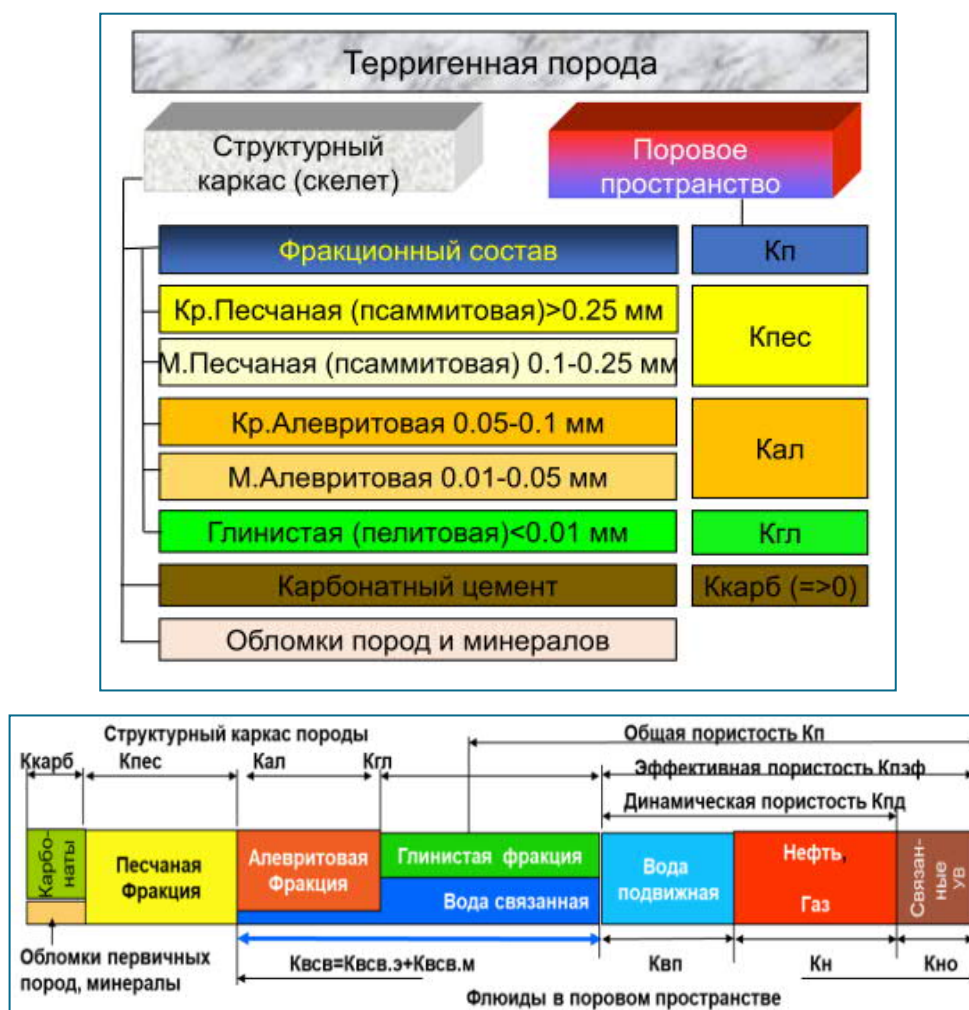
Рис. 1. Схема трехкомпонентной песчано-алеврито-глинистой породы и флюидальной модели порового пространства
