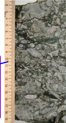
По результатам попластовой интерпретации данных ГИС с учётом данных керна были получены три типа пористостей: общая (КпНГК), матричная (КпАК) и вторичная (Кп вторичн.).
